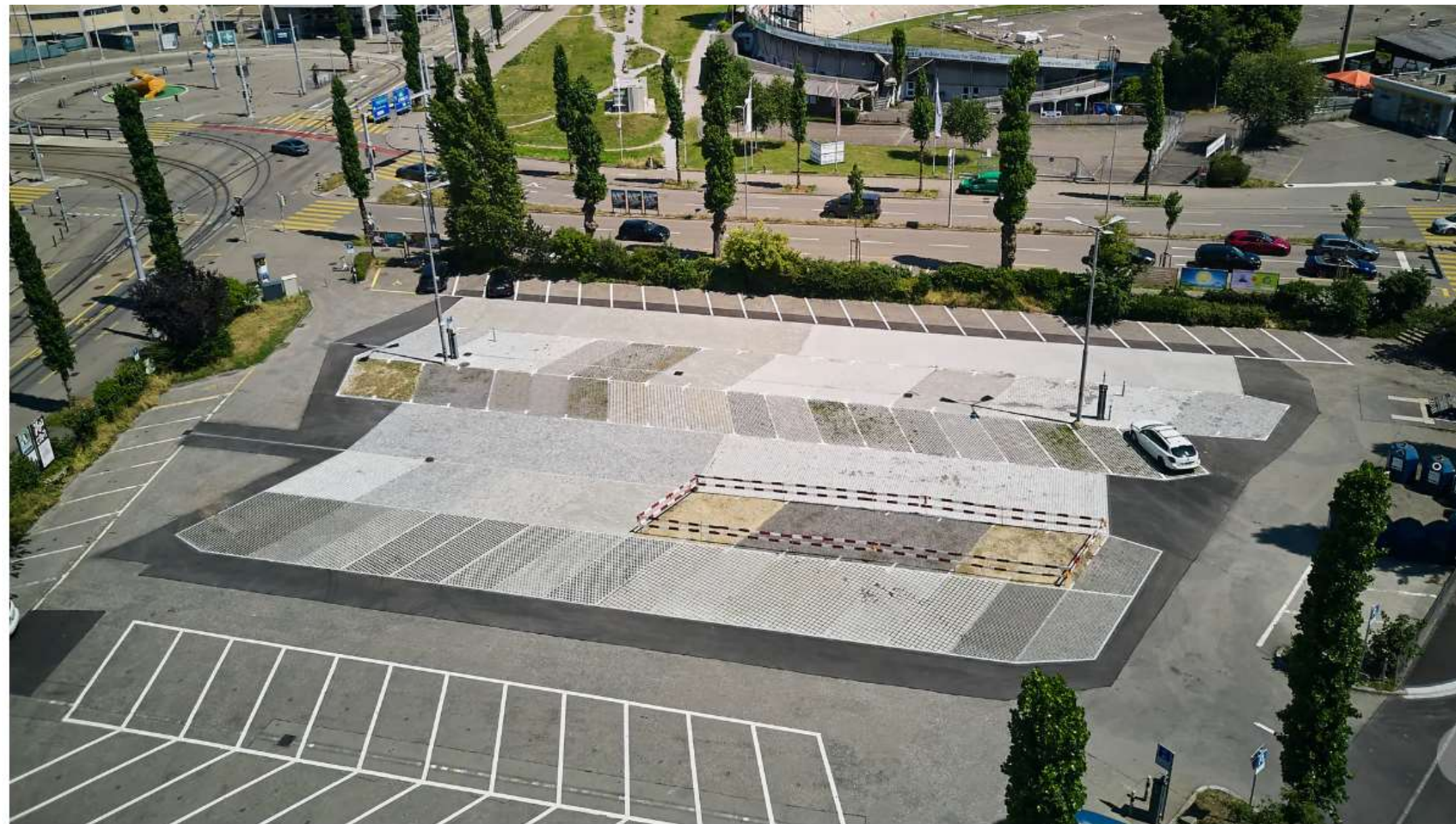
66 verschiedene Beläge und Unterbauten: Die Testanlage vor dem Theater 11.
