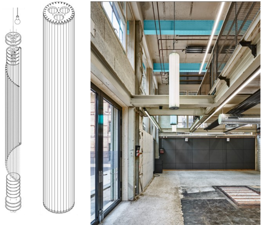
图 47: 灯具轴测图和安装在 K.118 入口处呈现出的实景效果 ©ZHAW
