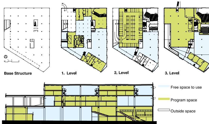
图 7: 各层平面图展示固定空间 (绿色填充) 和灵活空间 (浅蓝色填充); 剖面图展示主要主体混凝土结构 (浅蓝色填充) 和次级钢结构 (绿色填充) ©LACATON&VASSAL
