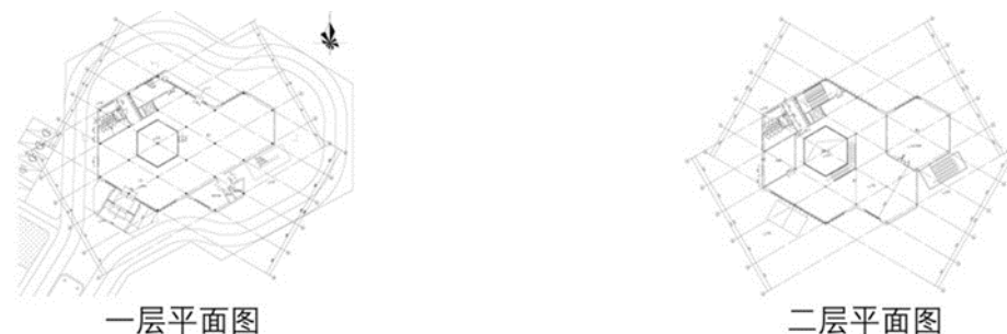
图 50: 陕西项目规划高度网格化、模块化。左：一楼，右：二楼 @陕西示范工程团队
