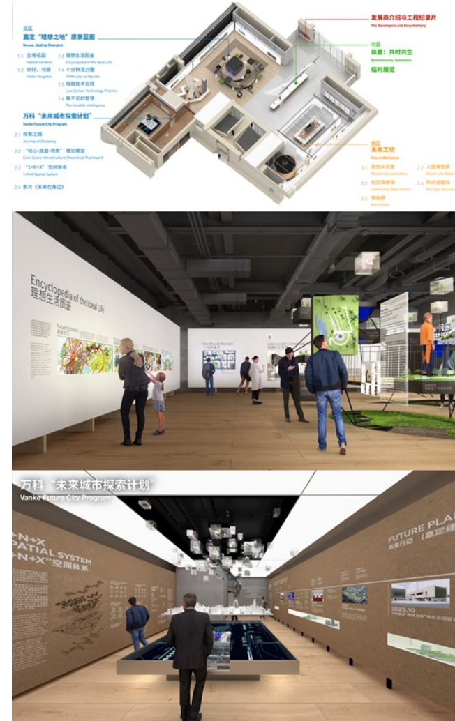
图 36：基于 2023 年 10 月 11 日提交的展陈设计平面图，瑞士团队就可能的建筑构件再利用提出建议；下半部分为展厅效果图；内部隔墙可采用木龙骨结构，并设计为双层木框架系统，以便满足相应的隔音和防火要求。©上海示范项目设计团队
