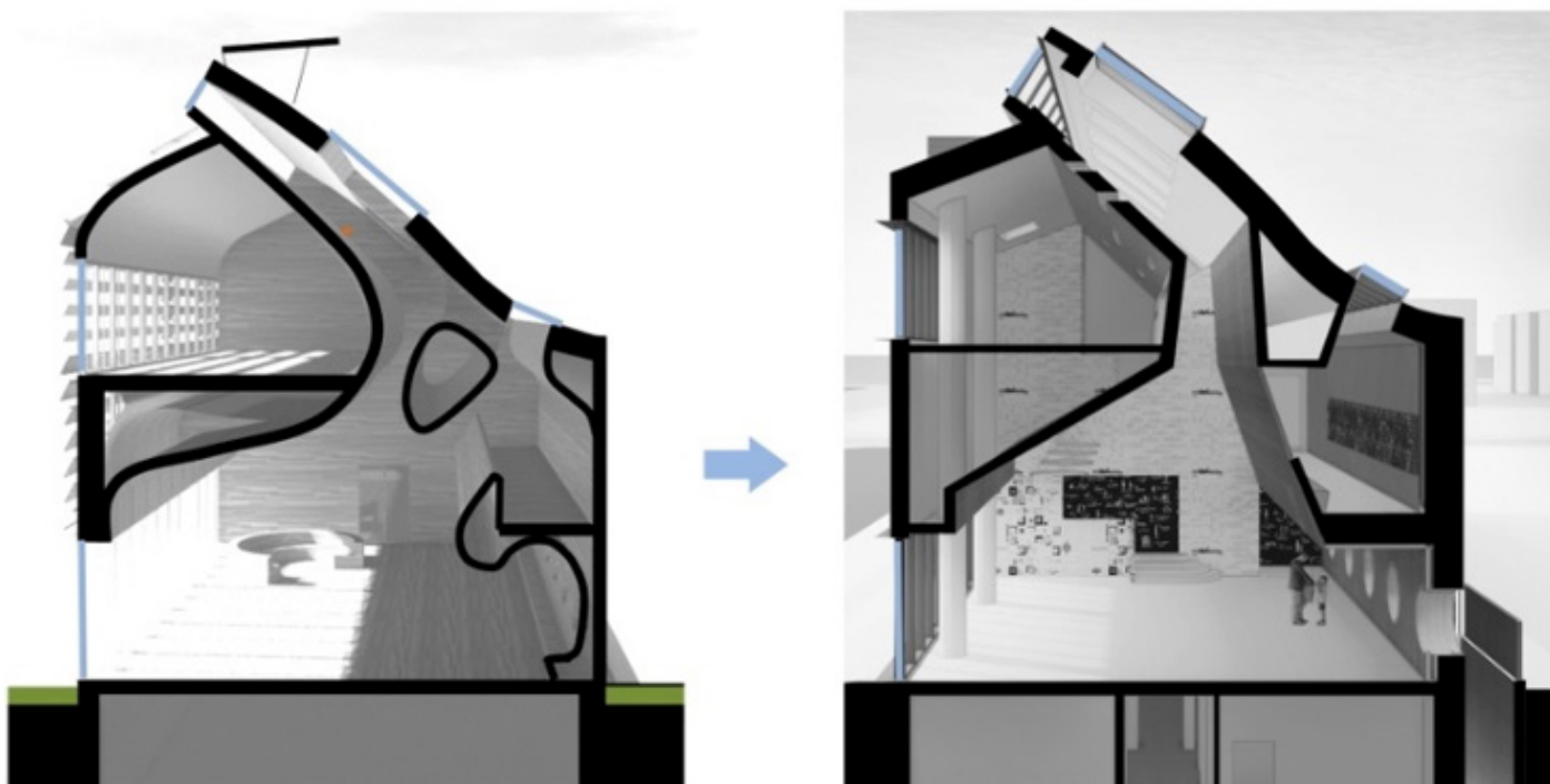
图6 应投资者要求, 设计团队将之前曲线形状的建筑简化为多边形, 经瑞士专家确认, 这种结构的自然通风效果更为有效, 并能为零能耗建筑项目的碳减排提供高质量的贡献 (图片来源: 项目汇报文本 2022 年 11 月 17 日, 素朴工作室)。
