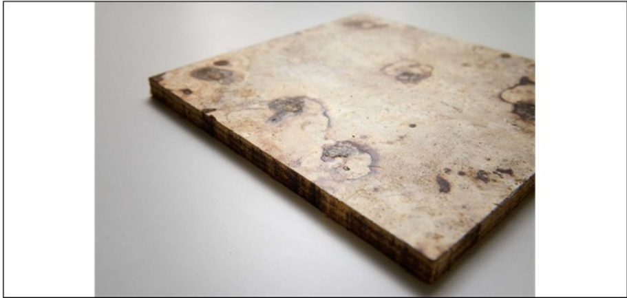
图 26 生物基建筑材料的研究：苏黎世联邦理工学院-新加坡未来城市实验室的“菌丝复合材料”项目；图片来源：苏黎世联邦理工学院-新加坡未来城市实验室
