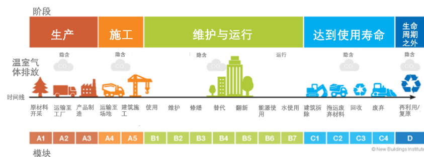
图 11 EN 15978 规定的建筑物生命周期评估模块；图片来源：NBI
