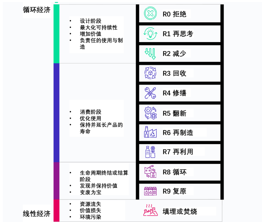
图 17 可持续利用初级资源的 R 策略层次结构；图片来源：circularise
