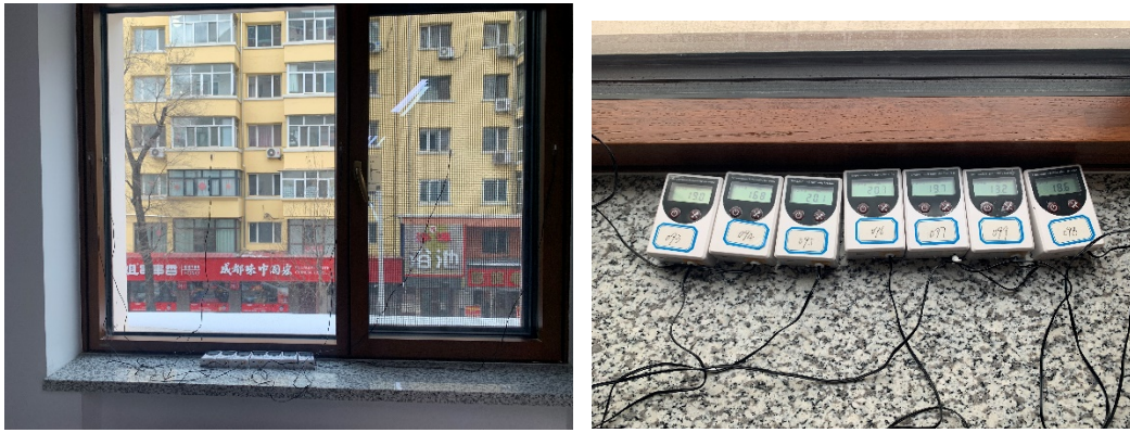
图 3 安装温度传感器监测玻璃不同位置温度
